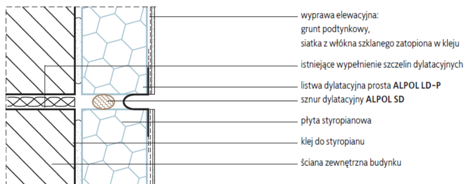
Rys. 3 Przykłady wykonania szczelin dylatacyjnych.
